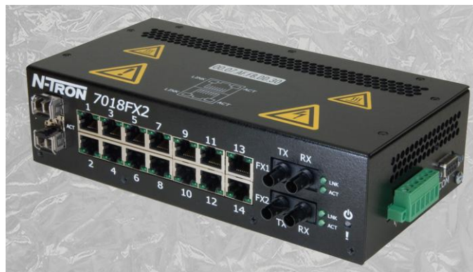
Abbildung mit installierten optionalen SFP Transceivern
